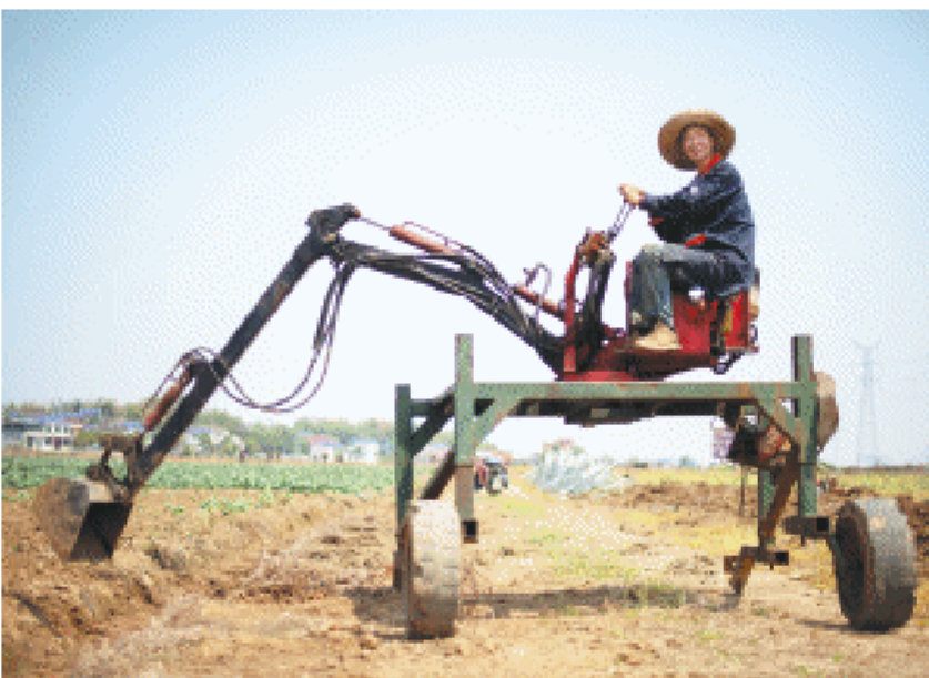
经过任亮的巧手改造，这台农用小挖机华丽变身，成了集松土、挖地等5项功能于一身的全地形挖机，极大地减轻了他和妻子打理菜地的体力负担。
